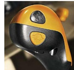
Das PowrReverser Plus Getriebe bietet insgesamt 32 Vorwärts- und 16 Rückwärtsgänge. Per Knopfdruck können Sie zwischen 2 unter Last schaltbaren Stufen wechseln.
