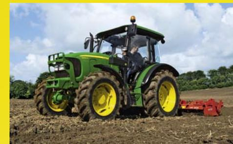
Mit einer maximalen Hubkraft von 42 kN an den Fanghaken und 29 kN am Fronthubwerk ist der 5R auch für schwere Beanspruchungen bestens gerüstet.
