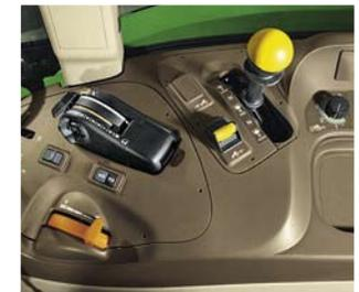
Die optionale elektronische Hubwerksregelung macht die Steuerung des Hubwerks schneller, einfacher und präziser. Das EHR-Regelventil und die Zug-/Lageregelung werden elektrisch betätigt. Die maximale Hubkraft liegt bei kraftvollen 3,6 t.
