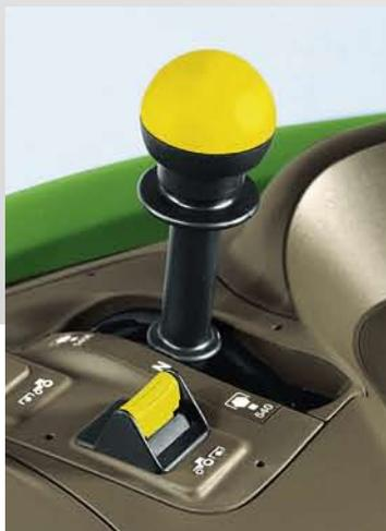
Der Hebel für die Zapfwellenzuschaltung liegt leicht zugänglich auf der linken Seite. Die Instrumententafel enthält Anzeigen für Motor- und Zapfwellendrehzahl, Fahrgeschwindigkeit, Tankfüllstand, Kühlmitteltemperatur und mehr.
