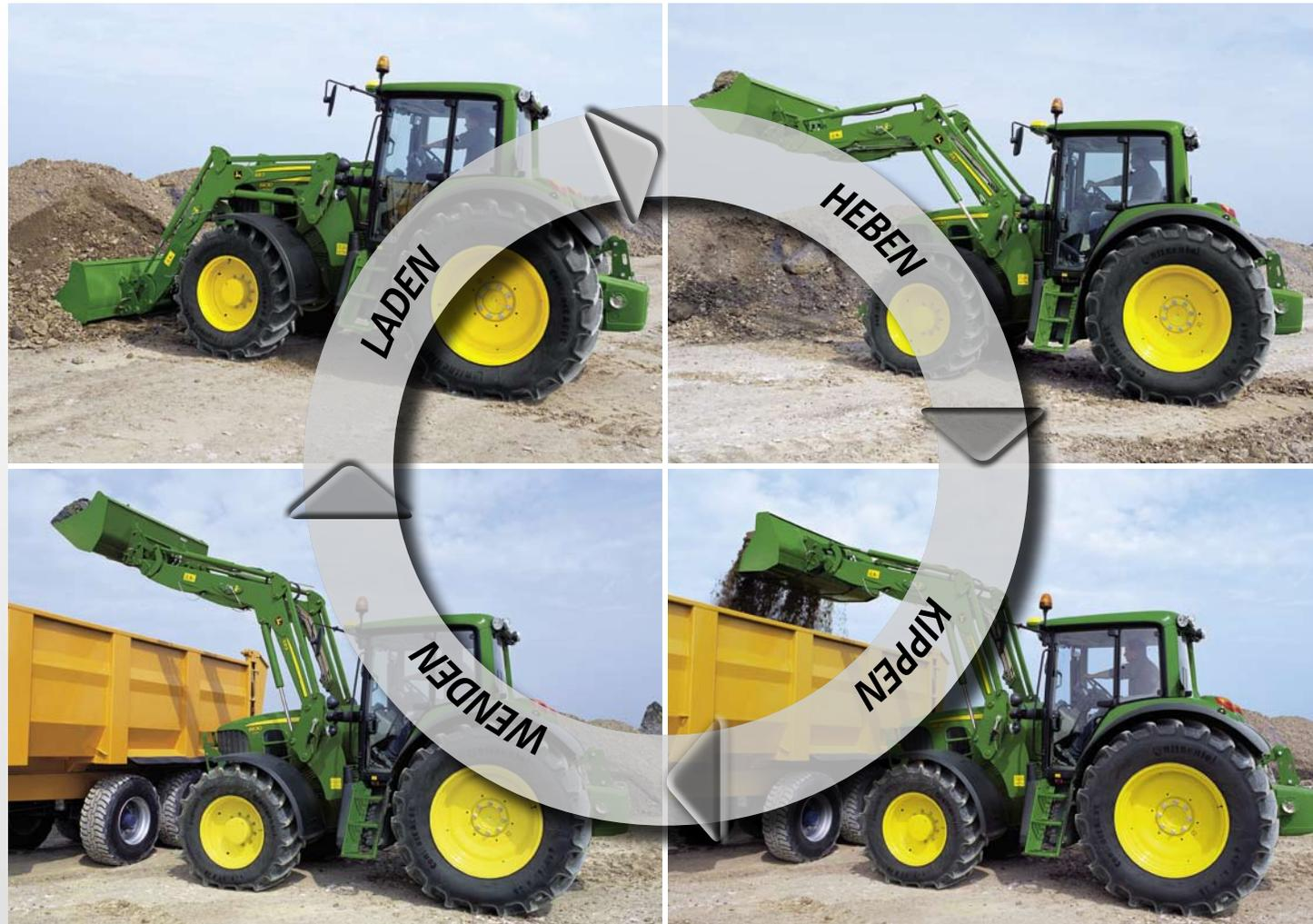
Das neue John Deere MemoSystem spart Zeit und Arbeit, wenn Sie oft wiederholende Arbeiten zu erledigen haben. Um Ihr Werkzeug in eine vorprogrammierte Position zu bringen, senken Sie einfach den Frontlader ab und drücken die entsprechende Taste auf dem Joystick.
