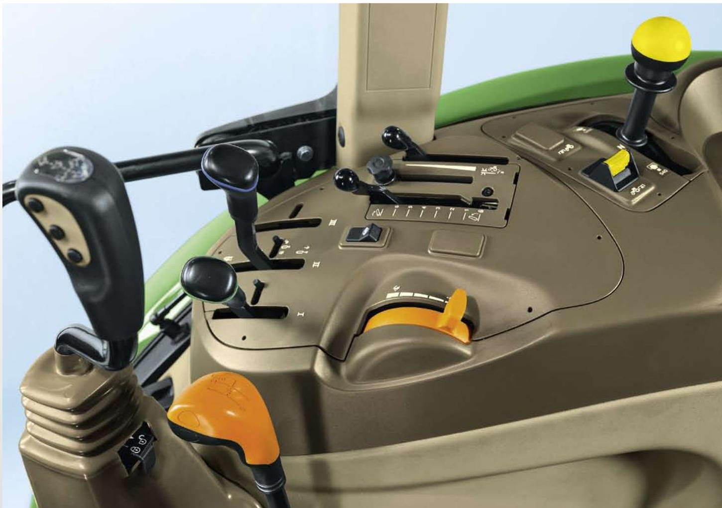
Die beiden Hebel der mechanischen Hubwerksregelung sind griffgünstig in die rechte Bedienkonsole integriert. Über einen der Hebel bedienen Sie die Lageregelung des Heckkrafthebers, über den zweiten die Zugregelung. Mit dem verstellbaren Anschlag wird das Hubwerk verriegelt und das Arbeitsgerät für den Transport gesichert.
