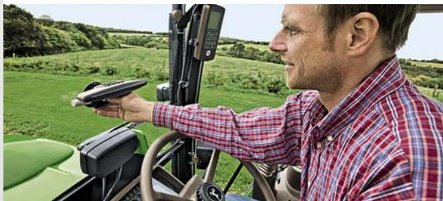
Jede rote Leuchtdiode auf der Anzeige stellt eine Abweichung von 10 cm von der von Ihnen eingestellten Ideallinie dar, die durch eine grüne Leuchtdiode ausgewiesen wird.
