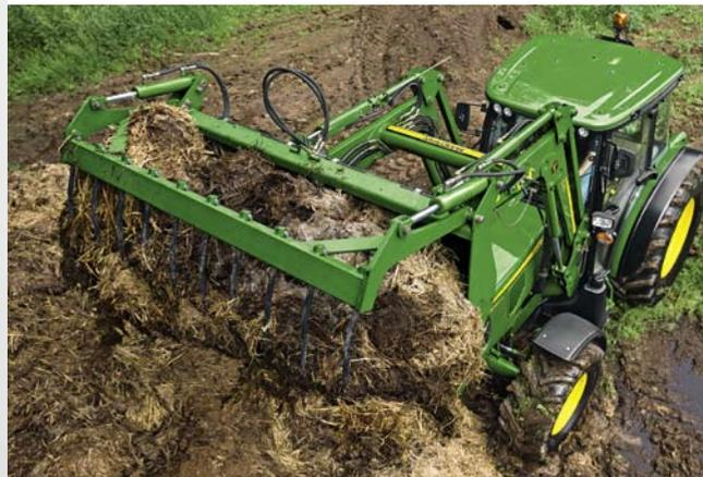
Das Frontladerpaket enthält alles, was Sie brauchen: Anbaurahmen, Schutz für die Motorhaube, einen mechanischen Joystick mit 2 Funktionen plus Verteilventil, einen Steuergeräteblock mit Druckbegrenzungsventil und einen Multikuppler.
