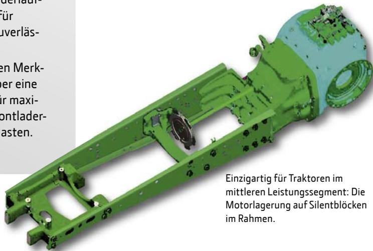
Einzigartig für Traktoren im mittleren Leistungssegment: Die Motorlagerung auf Silentblöcken im Rahmen.
