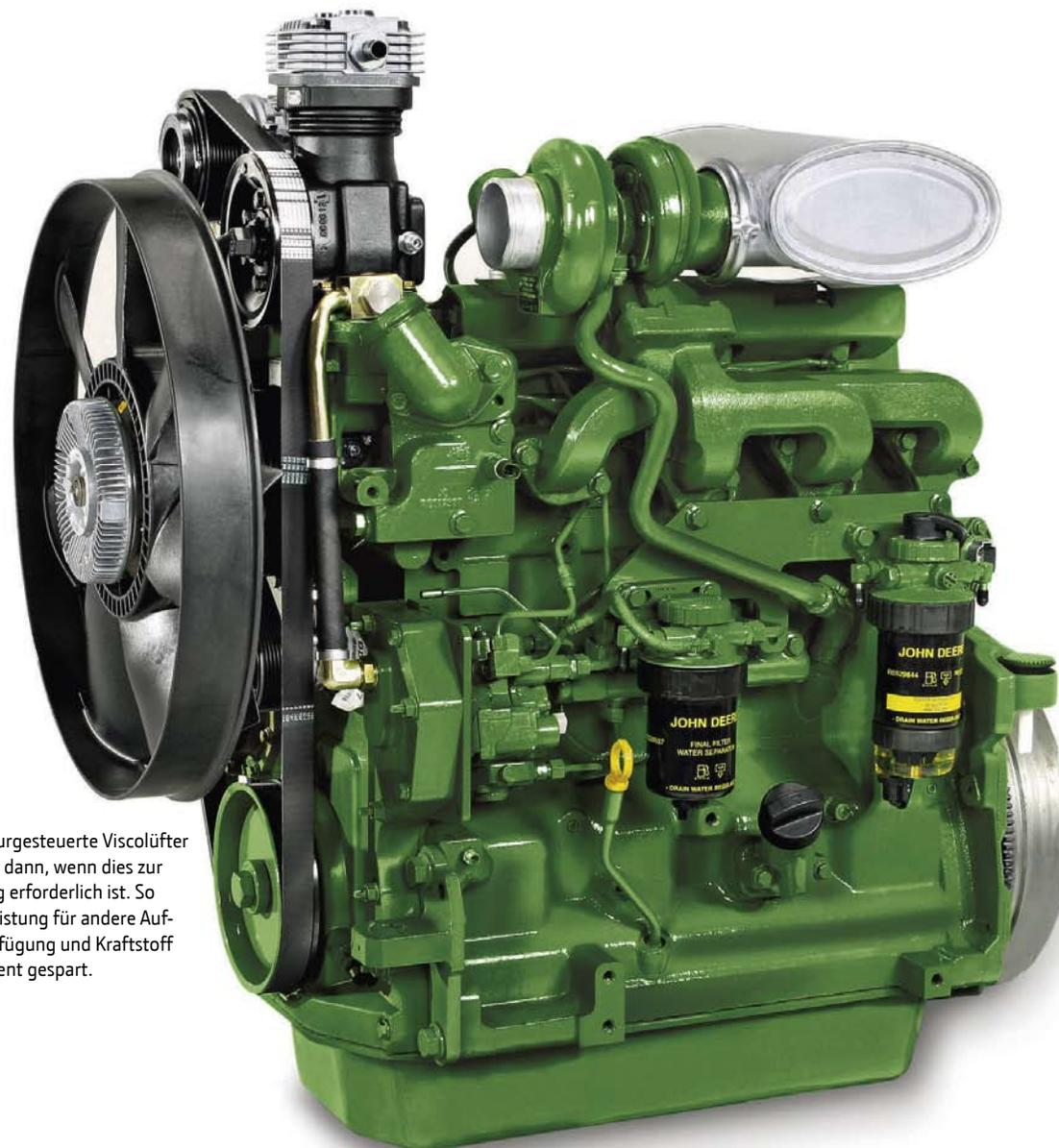
Der PowerTech Motor mit 4,5 Liter Hubraum ist bei Ölwechselintervallen von 500 Stunden (mit Plus50 Öl) äußerst wartungsfreundlich. Die Motoren erfüllen nicht nur die Abgasgrenzwerte der Stufe III (Tier III), sie bieten auch 7 % Extraleistung und überzeugen mit einem hohen Wirkungsgrad.
