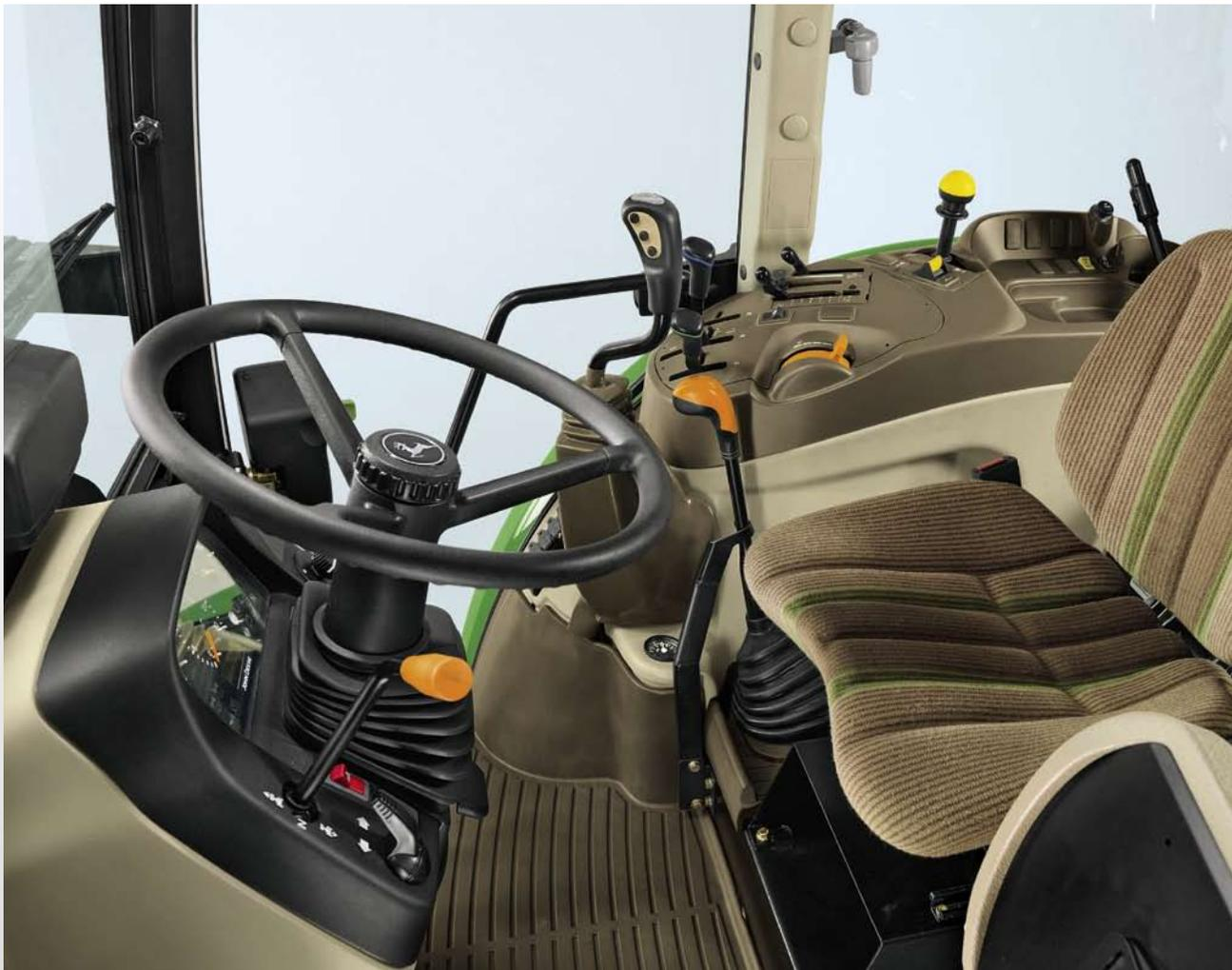
Der flache Kabinenboden bietet Komfort und Sicherheit. Mit serienmäßiger Kabine und der Bereifung (420/85 R30) misst der Traktor lediglich 2,54 m an Höhe – ideal für niedrige Gebäude.
