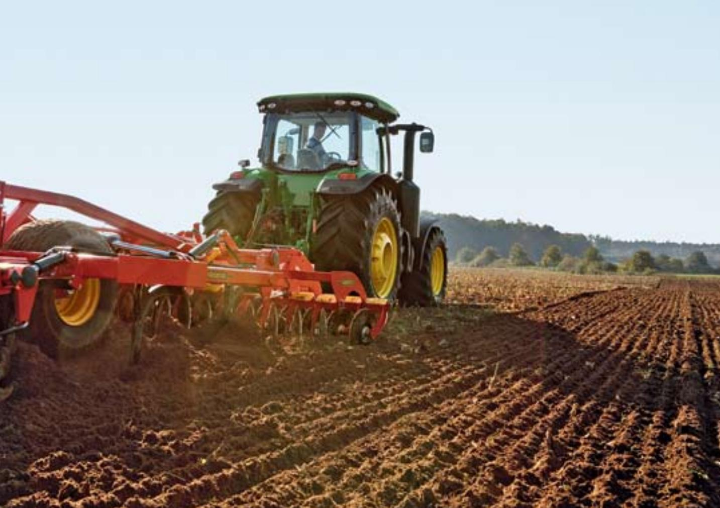
Traktoren der Serie 8R/8RT können mit 900 kg bzw. 1.150 kg Frontgewicht und mit 50 kg Koffergewichten für schnellen Ballastwechsel bestückt werden.
