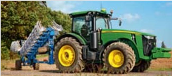
Die verbesserte Gewichtsverteilung unserer 8R/8RT Traktoren sowie der leistungsstarke Heckkraftheber ermöglichen das Heben selbst größter Anbaugeräte in der Dreipunktaufhängung.
