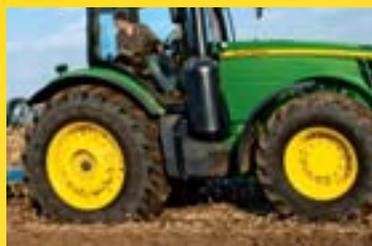
Mit wechselbaren Hinterradgewichten (75, 205 und 645 kg) lässt sich Ihr Traktor optimal ballastieren.
