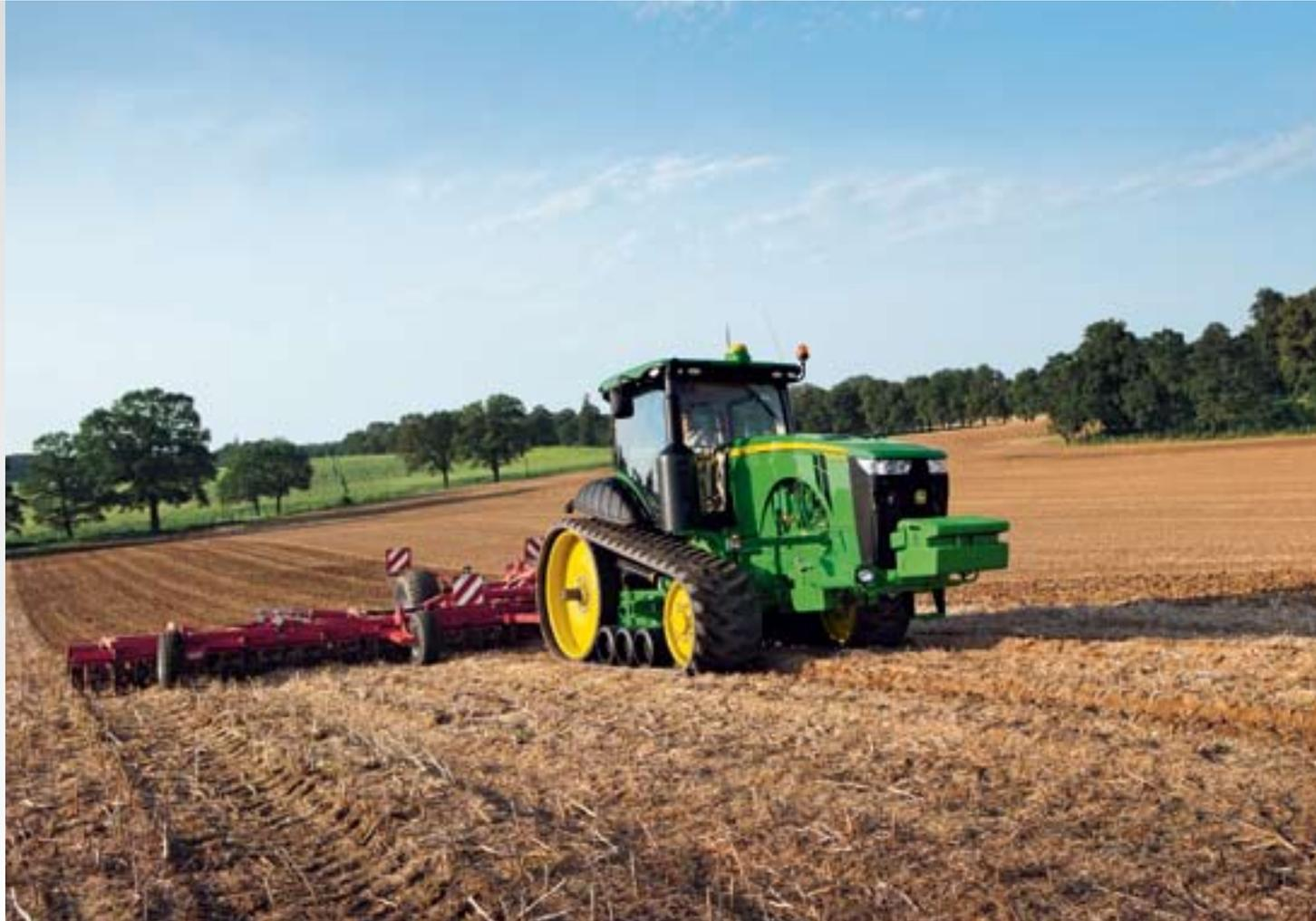
Mit dem bulligen 9,0 l PowerTech PSX Motor erzielen Sie mit den Raupenlaufwerken auf der Straße schnelle 42 km/h\*.
